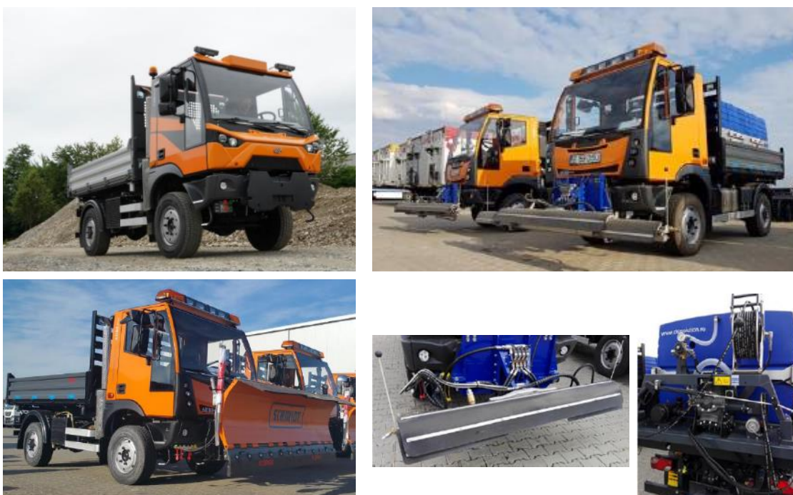
Figura 13-53: Vehicul de stropire și de dezăpezire recomandat
