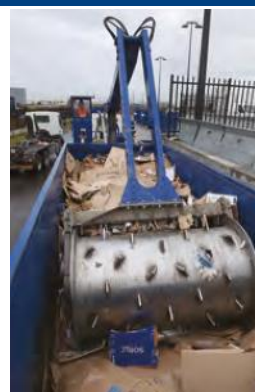
Figura 13-26: Exemplu – Compactor cu tambur mobil
